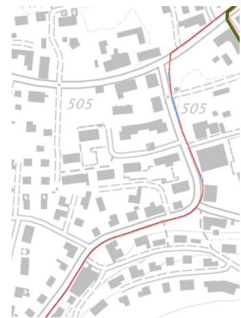
Abb. 25: Gewässernetzkarte (rot = unterirdisch)
