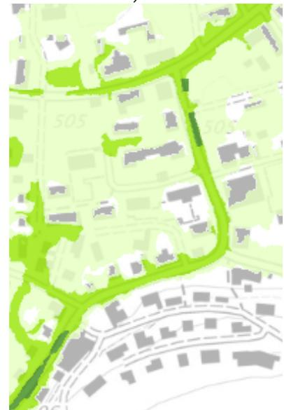
Abb. 28: Intensitätskarte HQ<sub>100</sub>, Munibach Abschnitt 2
