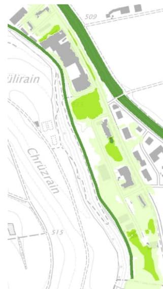
Abb. 16: Intensitätskarte HQ<sub>100</sub>, Mülibach Abschnitt 1
