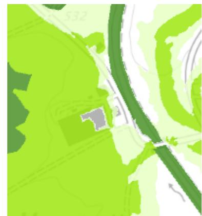
Abb. 42: Intensitätskarte HQ<sub>100</sub>, Luthern Abschnitt 1
