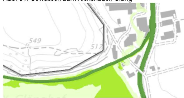
Abb. 53: Intensitätskarte HQ<sub>100</sub>, Rickenbach Gläng
